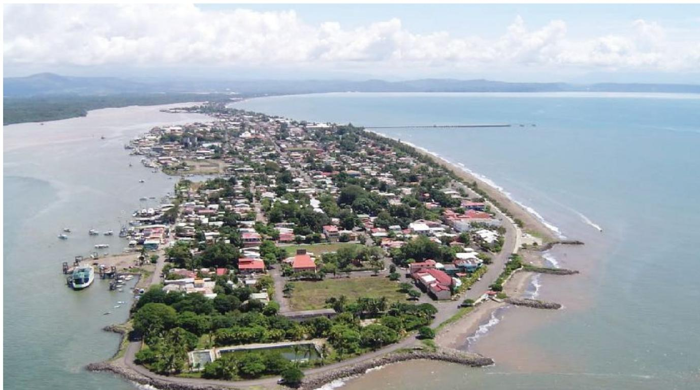
Figura No.1 Extremo oeste de la flecha de Puntarenas Con espolones de piedras para retener la arena debido a la erosión de la deriva litoral por falta aportes fluviales del río Barranca, cuyo material es indiscriminadamente utilizado por las empresas que sobre explotan el "cauce de dominio público.
