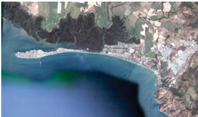
Figura No.2 Flecha litoral de Puntarenas enmarcando el manglar deltaico al norte. Al este la desembocadura del río Barranca, que con sus sedimentos alimenta la flecha. Al centro la Angostura parte más estrecha de la flecha. Al sur los sedimentos fluviales del Barranca transportados en suspensión, hacia el oeste, por la deriva litoral y que alimentan la flecha en arenas y limos.
